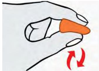
Rollen Sie den gesamten Gehörschutzstöpsel mit sauberen Händen zu einem möglichst engen, faltenfreien Zylinder.
