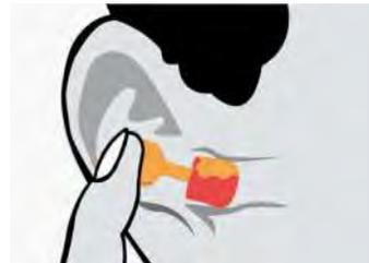
Setzen Sie den Stöpsel so ein, dass die Schaumstoffspitze weit in den Gehörgang hineinreicht. Drücken Sie den Stöpsel mit einer sanften Schaukelbewegung in den Gehörgang, um einen festen Sitz zu gewährleisten.
